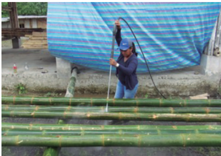
Figura 13. Limpieza de bambú con hidrolavadora, Ecuador
