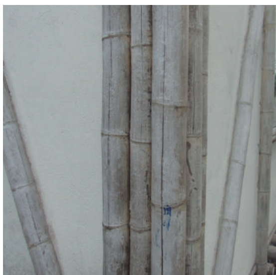
Figura 34. Rajaduras continuas de culmos Fuente: INBAR, 2021
