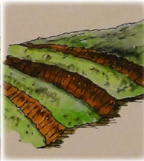
Realización de canales de desviación
